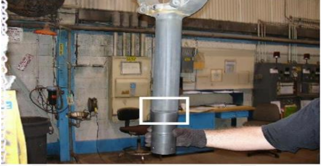
Şekil 2.11 Hasarları tespit edilen burun iniş takımı parçası
