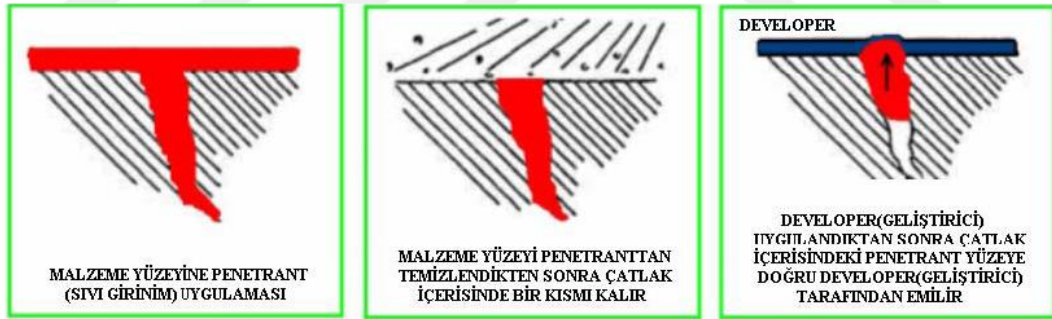
Şekil 1.7 Penetrantın uygulanması
