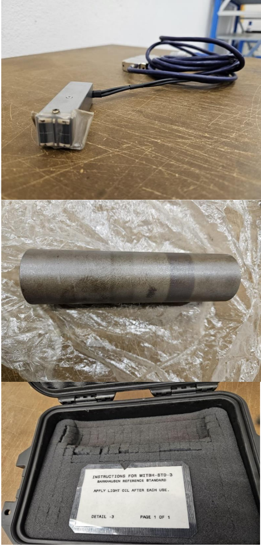
Şekil 2.19 Barkhausen cihazı probu ve referans standardı
