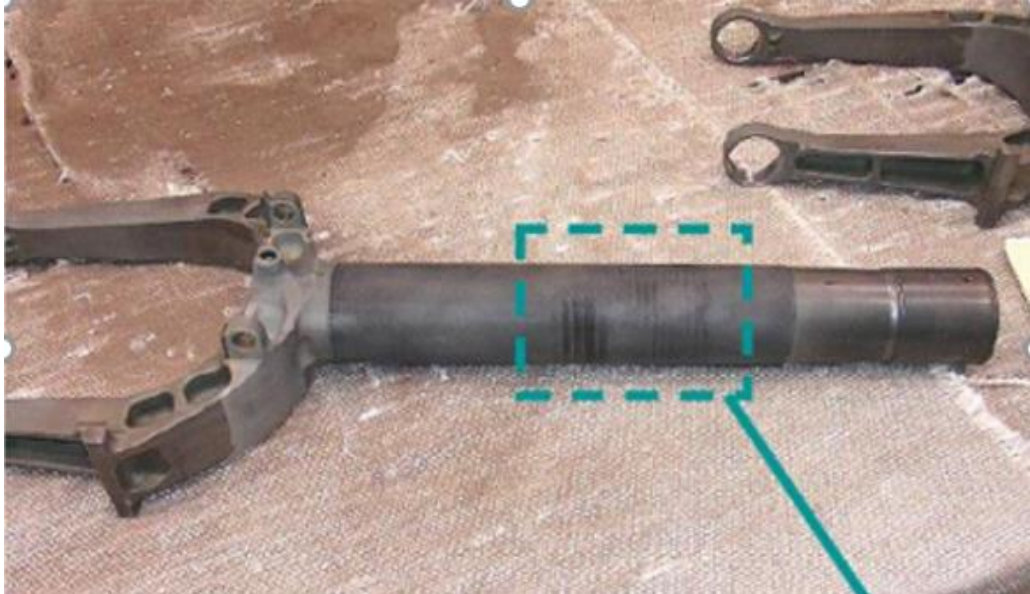
Şekil 2.10 Hasarları tespit edilen örnek burun iniş takımı parçaları
