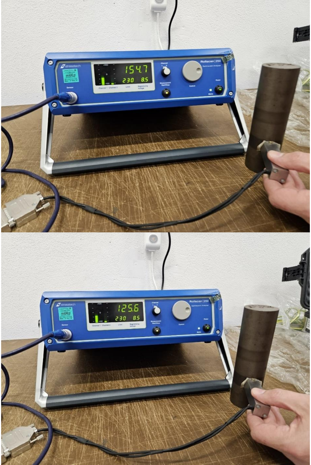
Şekil 2.18 Barkhausen cihazı kalibrasyonu
