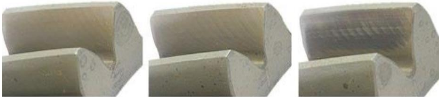
Şekil 2.13 Dişlideki taşlama yanığı örnekleri
