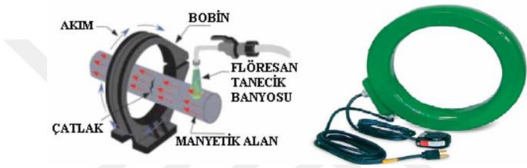
Şekil 1.14 Bobin ile parçada oluşturulan boyuna manyetik alan Kaynak: Megep, (2012)
