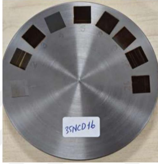
Şekil 3.1 35NCD16 Çelikte lazer ile oluşturulmuş yanık numuneleri
